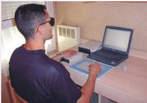
Le stylet tactile traduit les contrastes entre le blanc et le noir d'une page d'écriture en stimulations tactiles. Il permet donc, à l'aide d'une tablette graphique reliée à un ordinateur et à un stimulateur de lire sans voir.
